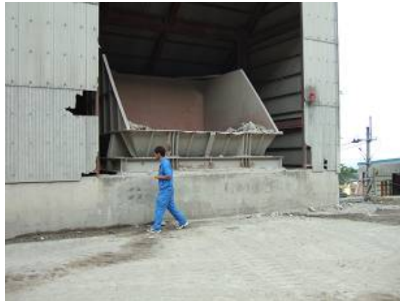
コンクリートの破砕機（この下に鉄筋の除去装置がある）
